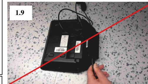
Obr. 1.9: Nežádoucí je také umístění adaptéru k „bradě“ zařízení. V obou těchto případech hrozí vyřazení některých důležitých komponent z provozu.
